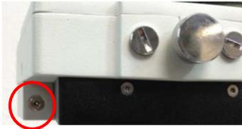
Anschluss für die Polsucherbeleuchtung an der Deklinationseinheit.
