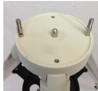
Ziehen Sie die Azimut-Einstellknöpfe heraus, um genügend Platz zu schaffen, damit sie die Befestigungsbolzen nicht blockieren. Setzen Sie den Montierungskopf auf das Stativ und achten Sie darauf, dass der Kopf nach Norden zeigt (oder nach Süden, wenn Sie in der südlichen Hemisphäre arbeiten). Installieren Sie die Unterlegscheibe (optional) und schrauben Sie die Azimut-Sicherungsmuttern von Hand auf die Befestigungsbolzen. Stellen Sie das Stativ ein, um die Montierung auszurichten.
