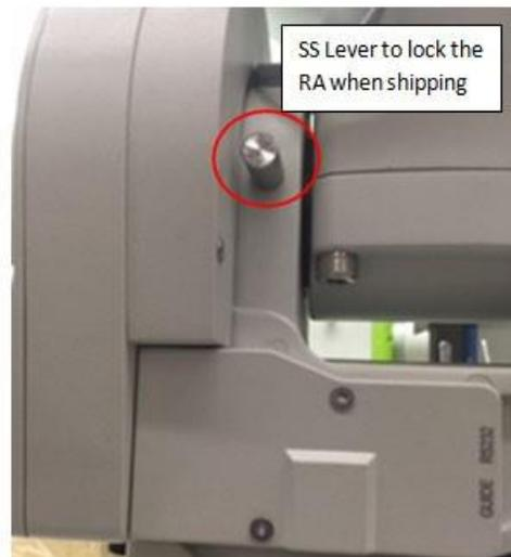
Entfernen Sie diesen Verriegelungshebel, damit sich die Montierung frei in der RA-Achse drehen kann. Stellen Sie sicher, dass der RA-Gangschalter eingerückt ist, bevor Sie den SS-Hebel entfernen.
