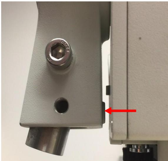
Am CEM60 GGW-Montagegehäuse befinden sich drei Schrauben: Eine Feststellschraube, eine Justageschraube auf der anderen Seite und eine Feststellschraube für geringer Breiteregrade (siehe Abbildung).
