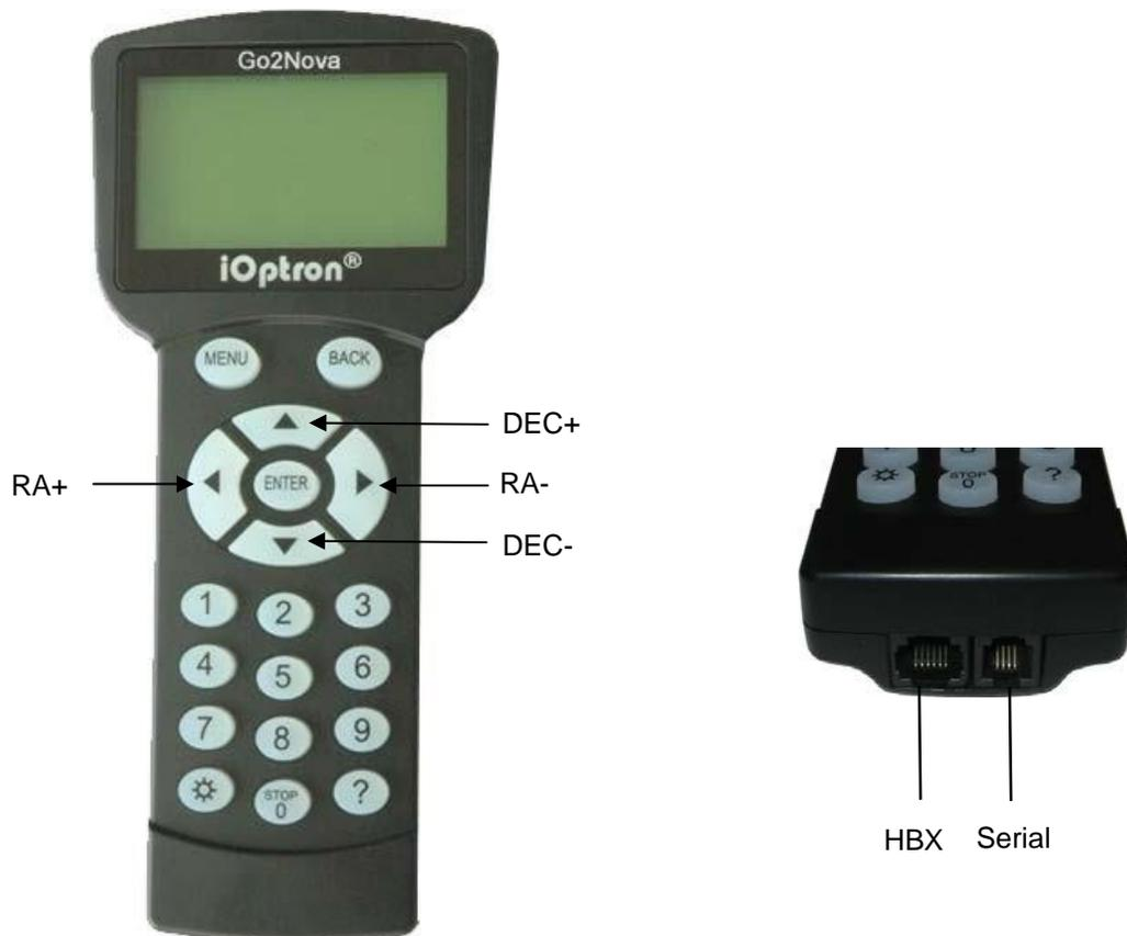
Der Go2Nova® 8407+ Handcontroller (HC) ist der Standardcontroller für die iEQ45 Pro-Montierung. Er hat einen integrierten Temperaturregler, der dafür sorgt, dass es bei -20°C (-4°F) betrieben werden kann. Der Handcontroller hat einen großen LCD-Bildschirm, Funktions-, Richtungs- und Zifferntasten auf der Vorderseite; ein rotes LED Leselicht auf der Rückseite; und eine HBX-Schnittstelle (6-polig) und eine serielle Schnittstelle (4-polig) an der Unterseite.
