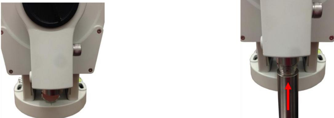
Abbildung: Gegengewichtswelle für eine zweiteilige Konfiguration installieren
