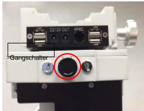
Das CEM-Zahnradsystem nutzt ein Magnetkraftsystem für eine optimale Verzahnung. Drehen Sie den Gangschalter vollständig im Uhrzeigersinn, um die Schnecke vom Schneckenrad zu lösen. Drehen Sie den Gangschalter gegen den Uhrzeigersinn, um das Schneckenrad wie auf der Montage angegeben einzurasten.
